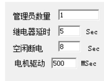
如要修改继电器延时、空闲断电、电机驱动时间参数可在 VeinLock.exe 软件中修改。
